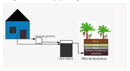
Como exemplificado acima este sistema é constituído por três fases dentre elas a caixa de gordura, o tanque séptico e o filtro de bananeira.
